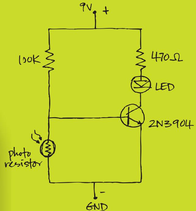
FINALLY, CONNECT THE BLACK LEAD OF THE BATTERY CLIP (GROUND). ATTACH A BATTERY TO THE CLIP. WHAT HAPPENS WHEN YOU COVER THE PHOTORESISTOR WITH YOUR THUMB? WHAT HAPPENS WHEN YOU SHINE A LIGHT ON IT? HOW COULD YOU REARRANGE THESE COMPONENTS TO MAKE A "LIGHT DETECTOR"?
