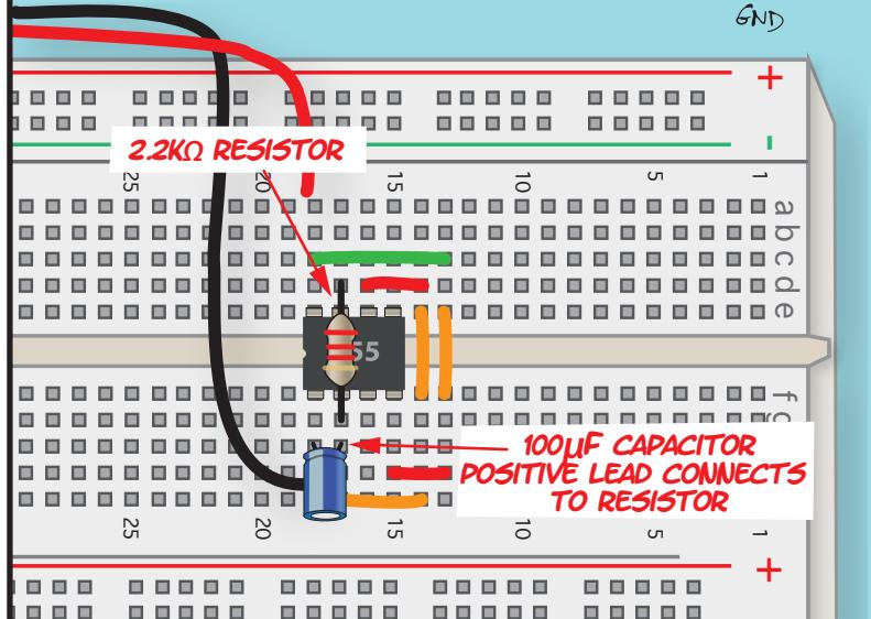
THE SPACE TIME DEPENDS ON THE VALUES OF THE RESISTOR BETWEEN PINS 2 AND 7 AND THE CAPACITOR.
