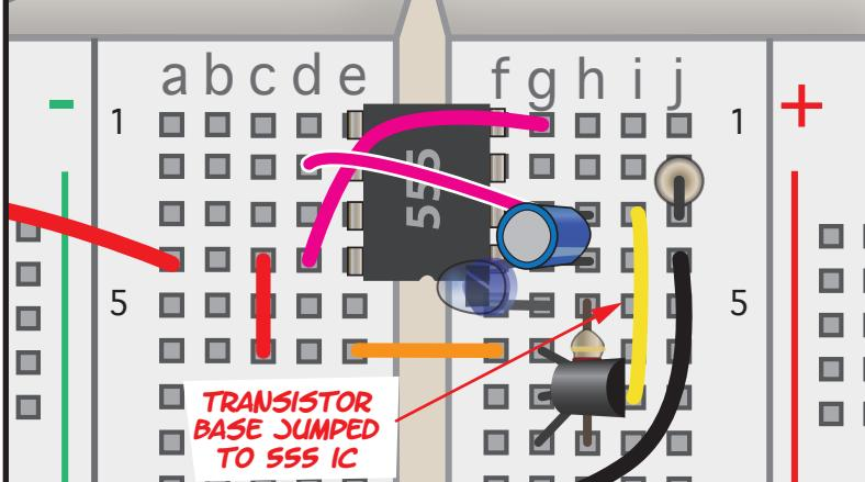
A FINAL JUMPER BETWEEN THE 555 AND THE TRANSISTOR BASE ALLOWS THE IC TO CONTROL IT. WHAT HAPPENS WHEN YOU ATTACH THE BATTERY? WHY? WHAT HAPPENS IF YOU CHANGE THE VALUE OF THE CAPACITOR?
