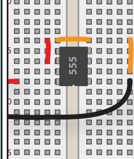
YOU CAN MAKE THIS CONNECTION BY BENDING ONE JUMPER WIRE OVER THE BACK OF THE CHIP, OR BY USING THREE FLAT JUMPER WIRES TO GO "AROUND" IT, AS SHOWN HERE. THIS METHOD USES MORE PARTS, BUT GIVES A NEATER BREADBOARD. YOUR JUMPERS WILL LAST LONGER, TOO, IF YOU DON'T BEND THEM AROUND TOO MUCH.
