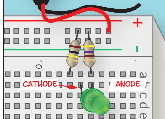
ADD THE LED. CONNECT THE ANODE (LONG LEAD) TO THE 470Ω RESISTOR.
