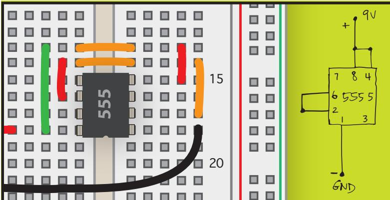
IN ASTABLE MODE, PIN 4 IS DIRECTLY CONNECTED TO POWER/PIN 8, WHICH IS ALSO ON THE OPPOSITE SIDE OF THE CHIP. BEND A JUMPER WIRE OVER THE BACK OF THE CHIP OR GO "AROUND" AS BEFORE.
