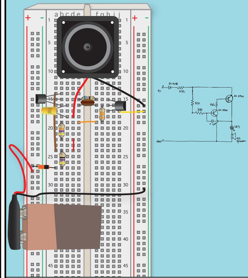
CONNECT THE BLACK BATTERY CLIP LEAD TO THE GROUND BUS, THEN TOUCH THE CONTACTS OF A 9V BATTERY TO THE CLIP TERMINALS. WHAT HAPPENS NOW?
